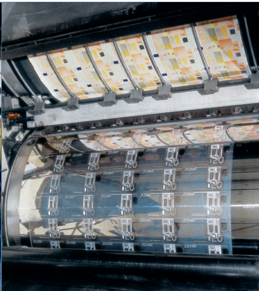
Ploščni valj za tiskanje bankovcev za 50 € v tiskarskem stroju za globoki tisk.
