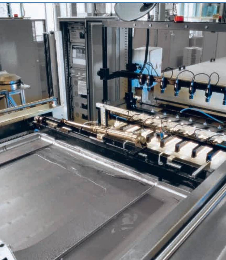
Een zeefdrukmachine voor het aanbrengen van de van kleur veranderende inkt op bankbiljetten van € 50.
